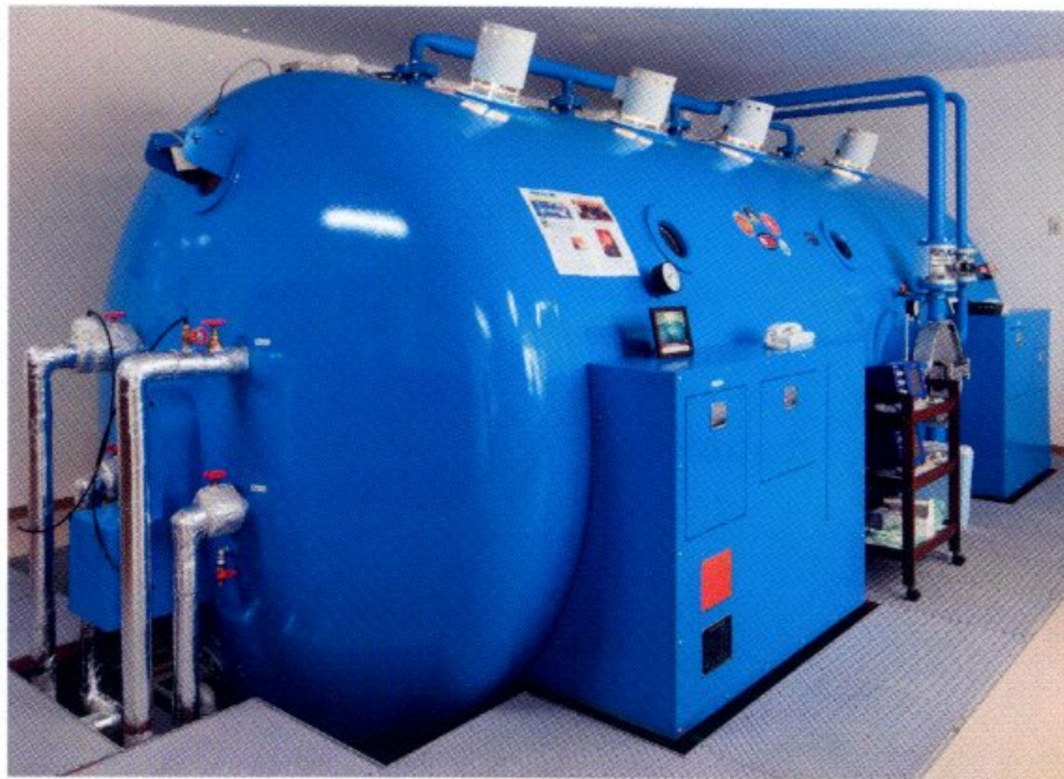
図 1. 第 2 種(多人数用)高気圧酸素治療装置 2ATA(絶対気圧)に空気加圧し、マスクにて純酸素吸入を 60 分間行う。
