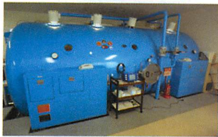
第2種高気圧酸素治療装置では8人が一斉に治療できる。治療時間は1時間半程度
