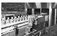
日田天領水の衛生的な最新設備を備えた工場内は、ゾーニングや陽圧管理がされ、HACCPシステムによる衛生管理を取り入れています。さらに安全性に対する取り組みをより強固なものにするために、2011年4月に「ISO22000」、2021年3月には「FSSC22000」の認証を取得しています。
